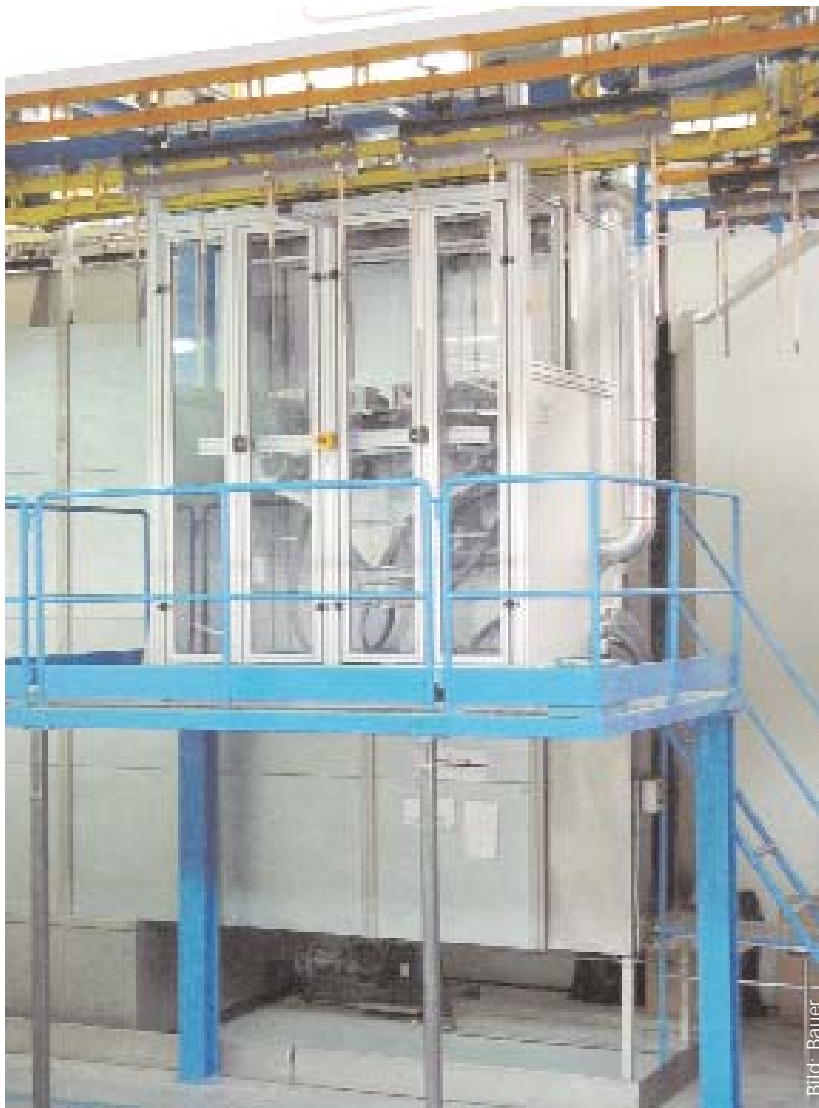
Wirbelstrom-Entlackungsanlage. Damit kann jeder Lacktyp gelöst werden. Die Wirbelstrom-Einwirkzeit beträgt nur wenige Sekunden.
