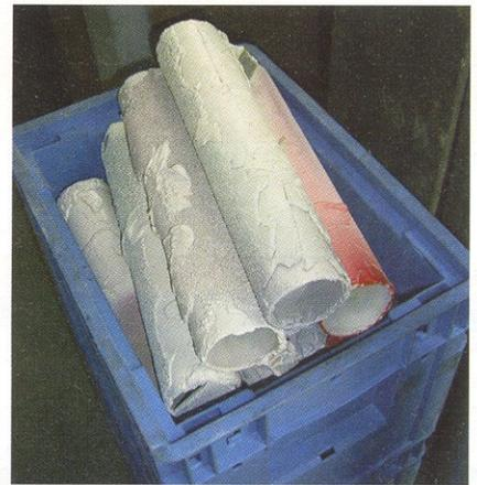
system zum Entschichten arbeitet mit einem Druck von 2.500 bar. Der Wasserstrahl durchbohrt dabei beim Aufprall Lackrückstände, sprengt sie ab und zerkleinert sie. Dieses Verfahren ist für robuste, schwere Werkstücke geeignet.
